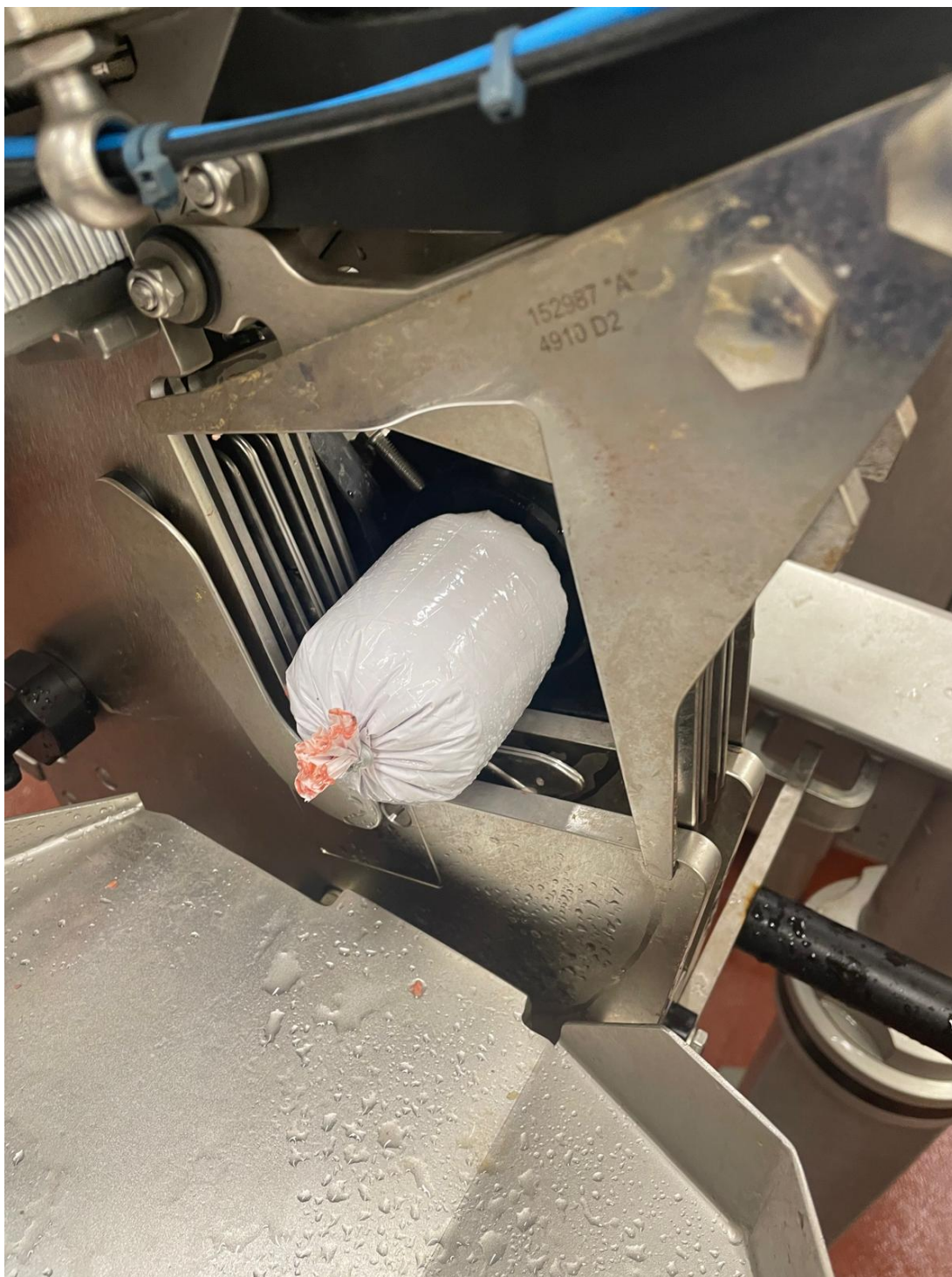
Obr. 13. Ukázka narážení směsí do sterilizačních střívek (foto R. Gebauer).
