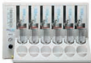
Automat na filtrace a zakoncentrování vzorků DryVap od výrobce Horizon Technology
