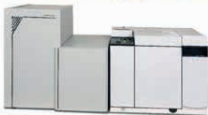
GC-MS BenchTOF firmy Markes International s unikátní selektivní ionizací a softwarem
