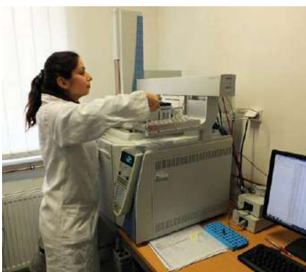
Doktorandka Sarvenaz Khalili provádí analýzu mastných kyselin na plynovém chromatografu.
