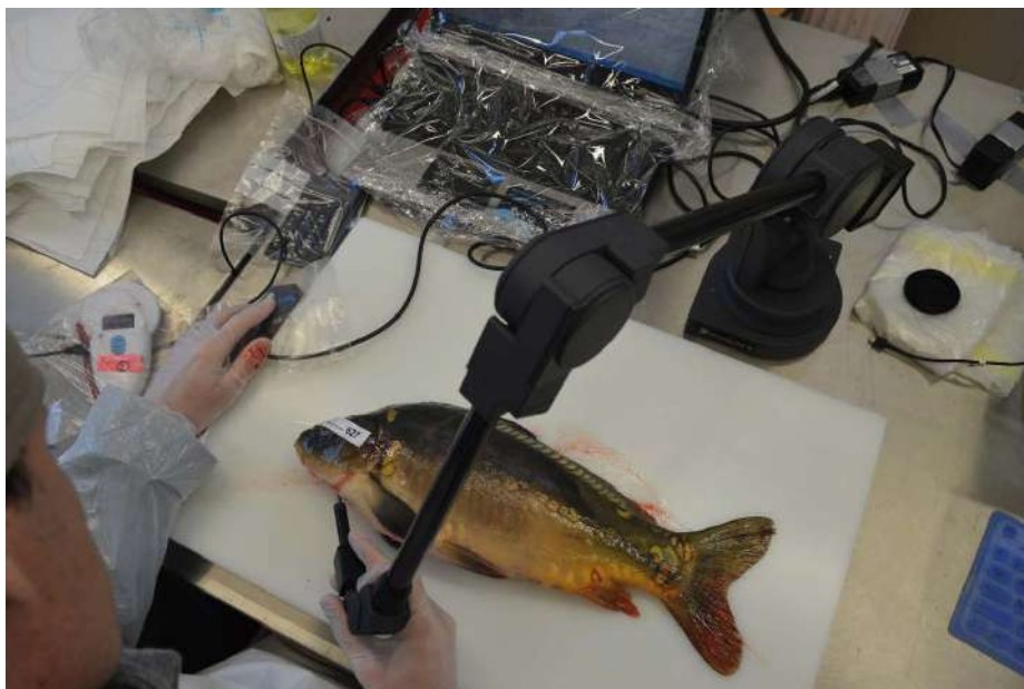
Digitalizace externích morfologických ukazatelů u Amurského lysce pomocí 3-D ramene v rámci projektu FishBOOST.
