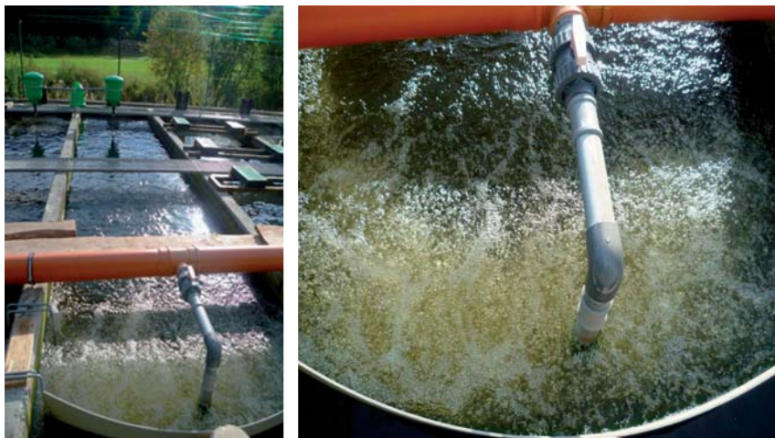
Obr. 9. Detail odchovného žlabu (vlevo) a airliftu (vpravo).
