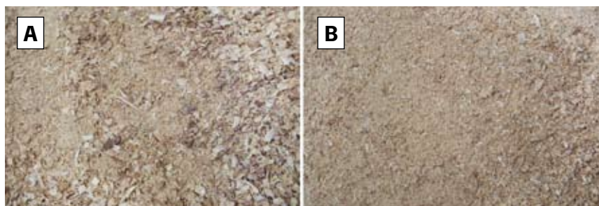
Obr. 10. Hrubé piliny (A) je nutné prosít, abychom dosáhli jemných pilin (B) vhodných k použití do směsi se sádrou.
