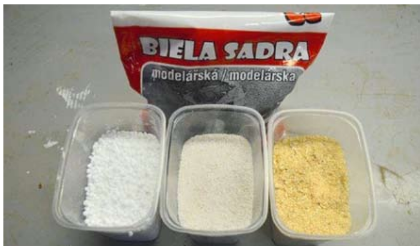
Obr. 11. Plnicí směs ze sádry a pilin vylehčíme použitím perlitu či polystyrenu.
