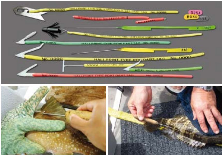
Obr. 3. Různé typy externích značek (nahore), aplikace externí značky pod hřbetní ploutev (dole) (Foto Hallprint).
