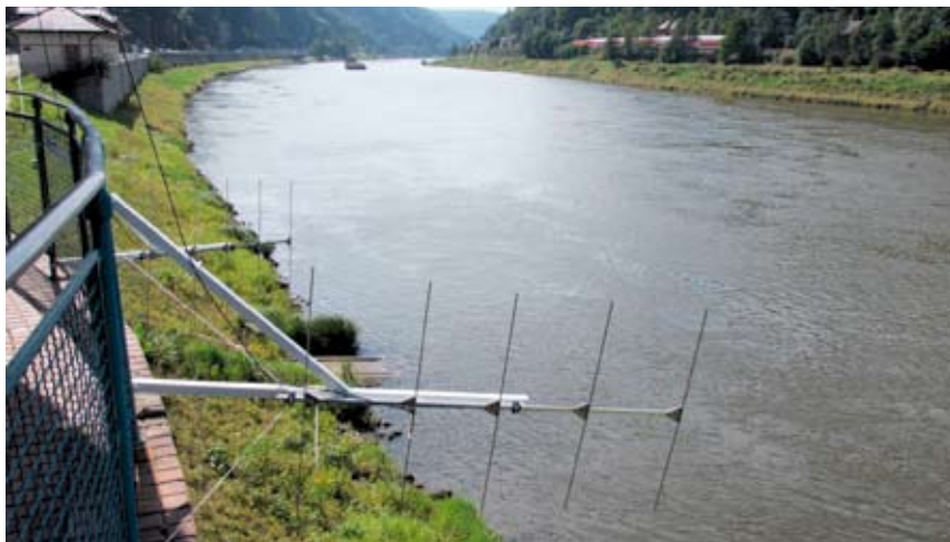
Obr. 14. Umístění antén stacionární automatizované stanice na Labi ve Hřensku (Foto P. Horký).
