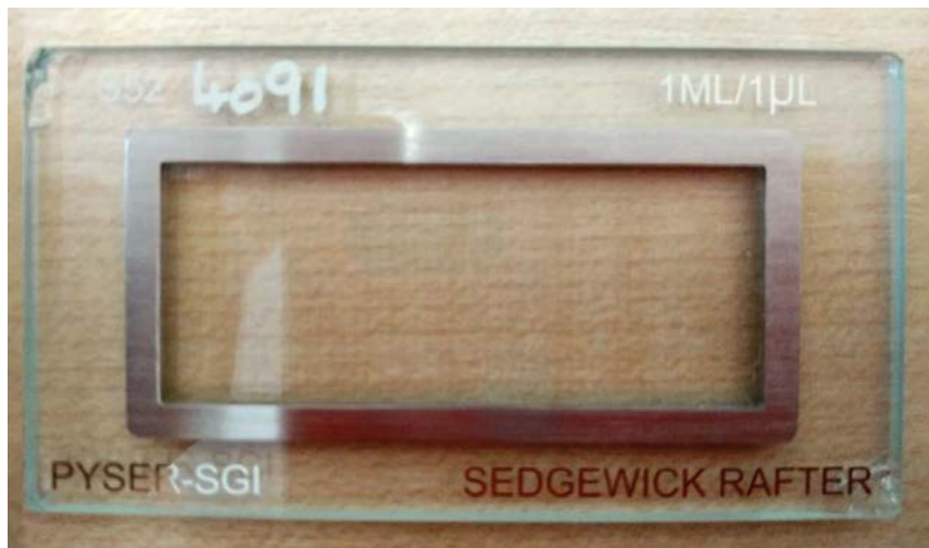
Obr. 6. Sedgewick-Rafterova počítací komůrka využívaná při zjišťování hustoty kultury vířníků (Foto: C. Yanes-Roca).
