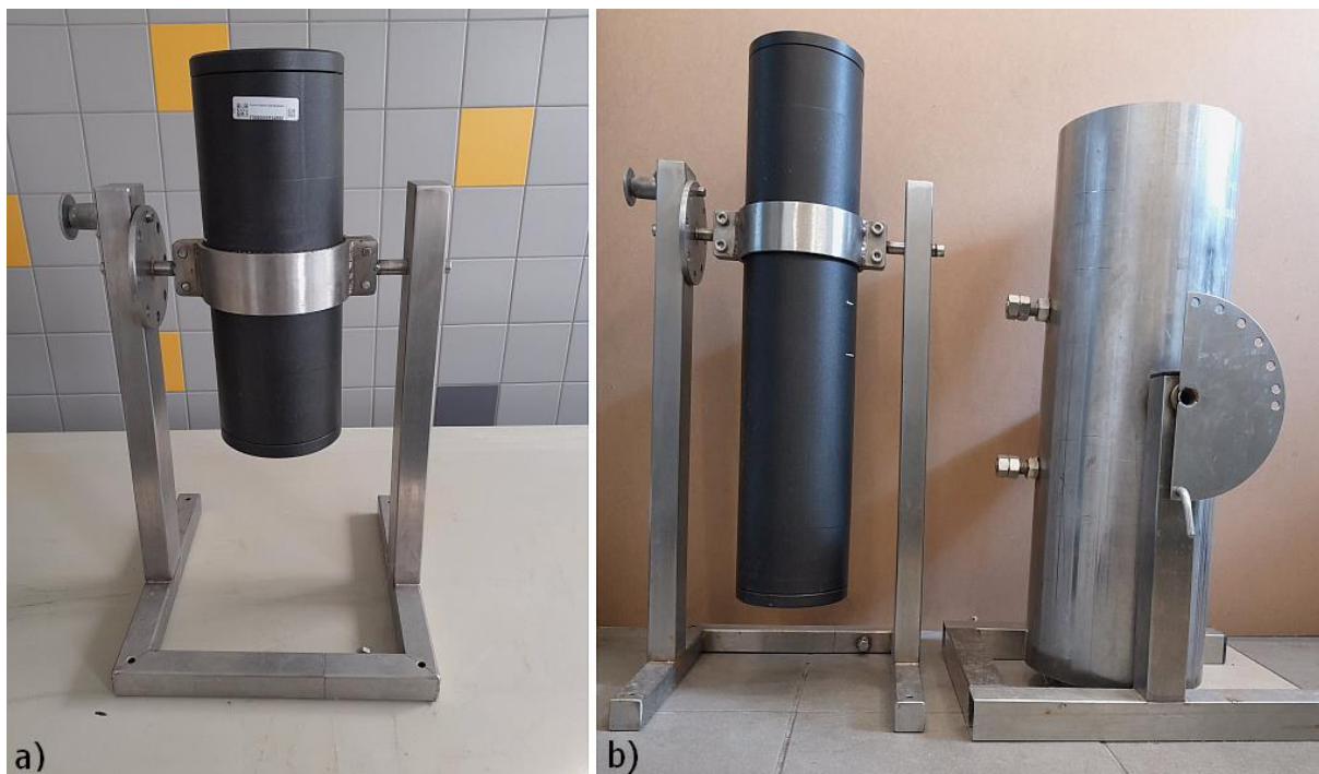
Obr. 5. a) silnostěnná tlaková komora o vnitřním objemu 1 l pro experimentální maloobjemové indukce triploidie; b) vlevo silnostěnná tlaková komora o vnitřním objemu 3 l pro poloprovozní a provozní indukce triploidie a vpravo v ochranném plášti z nerezové oceli tlaková láhev o vnitřním objemu 7 l pro provozní indukce triploidie. Všechny tři tlakové komory jsou umístěny v nerezových stojanech s aretací, které umožňují po provedeném šoku tlakovou komoru ve stojanu vyklonit a ošetřené jikry s vodou vylít (Foto M. Flajšhans).
