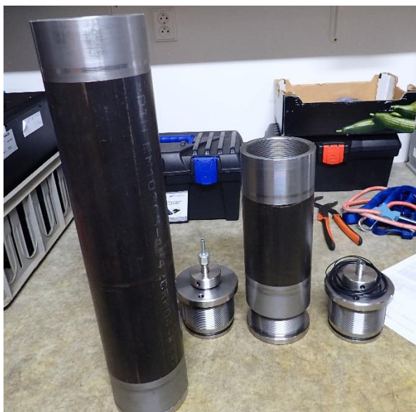
Obr. 6. Obě silnostěnné tlakové komory (s vnitřním objemem 3 l i 1 l) v průběhu výroby v SZDT, s.r.o. v Lišově. Vedle komor jsou demontovaná (vyšroubovaná) horní víka. Na maloobjemové tlakové komoře vpravo je i částečně vyšroubované dno. Tyto úpravy umožňují úplné vyčištění vnitřního prostoru komory v případě, že by v ní byly ošetřeny nedokonale odlepkované jikry (Foto M. Flajšhans).
