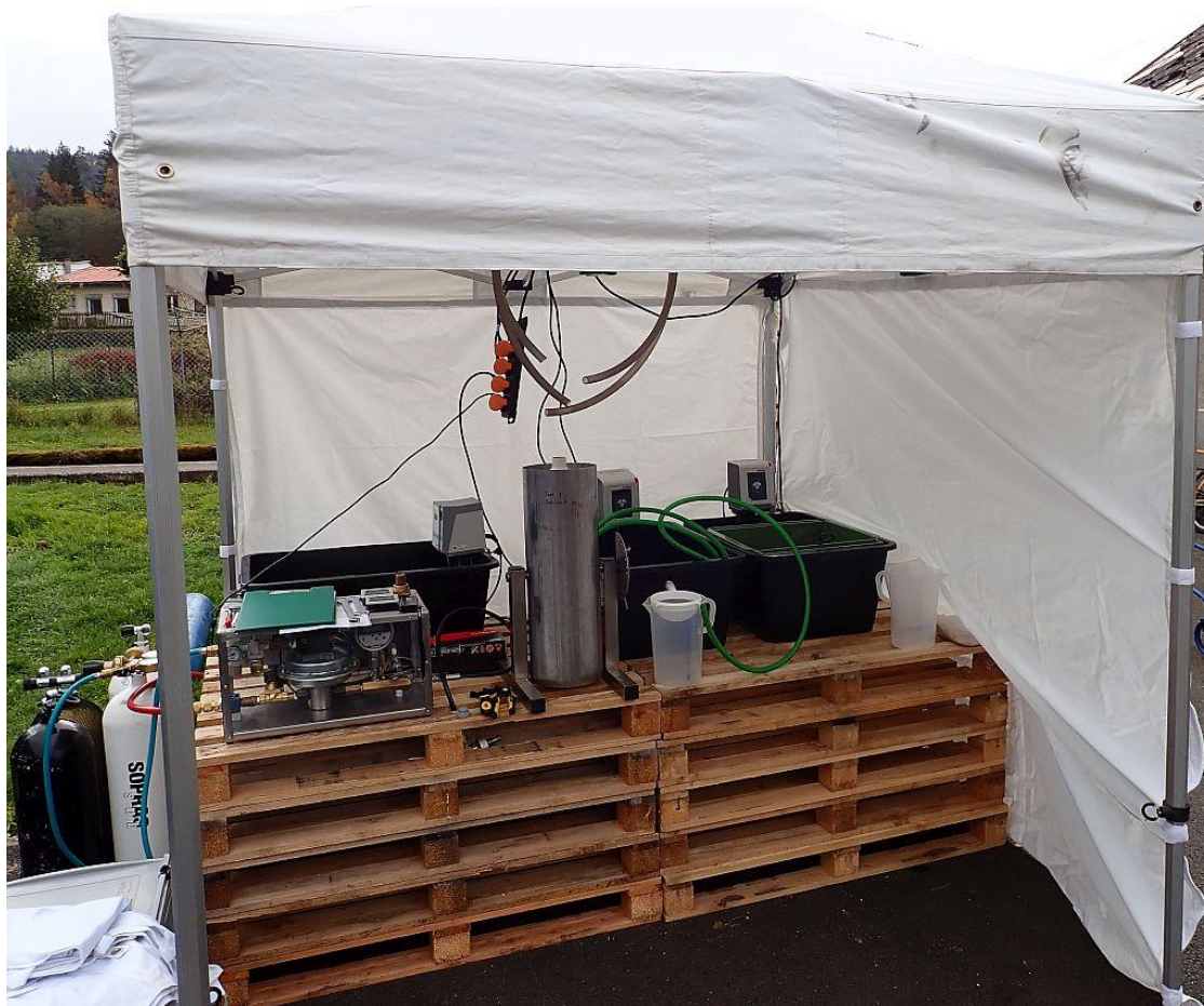
Obr. 4. Ukázka technologické sestavy pro indukci triploidie šokem hydrostatickým tlakem pro práci v terénu. Vlevo mimo stan zásobní láhve se stlačeným vzduchem, na paletách vysokotlaký kompresor s pojistným ventilem, vysokotlakými hadicemi, redukčním ventilem a násobičem, uprostřed tlaková láhev (komora) v ochranném nerezovém plášti. Vzádu a vpravo inkubační vaničky s vložkami a termostaty pro řízenou inkubaci jiker do začátku šoku (Foto M. Flajšhans).
