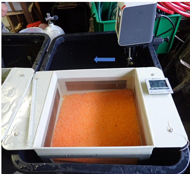
Obr. 3. Vanička s inkubační vložkou s oplozenými jikrami pstruha obecného potočního k jejich uchování do začátku šoku. Na bočním lemu vložky jsou položeny stopky odměřující čas od aktivace gamet do začátku šoku. Za vložkou je vidět montáž závěsného termostatu na bok vaničky. Modrá šipka naznačuje směr výtoku vody z termostatu (Foto M. Flajšhans).
