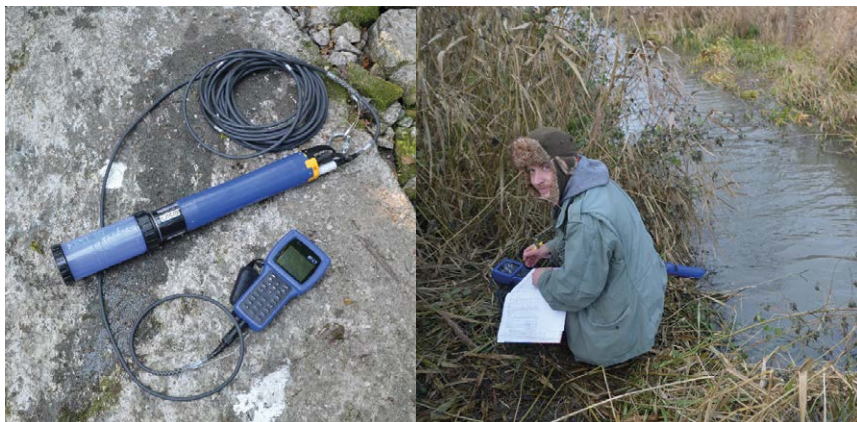
Obr. 4.1. Měření základních fyzikálně-chemických parametrů vody ve stoce pod rybníkem pomocí sondy YSI EXO 2 (Foto: J. Regenda).
