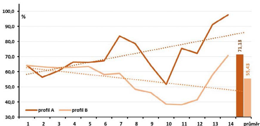
Obr. 4.9. Změna podílů TOC na TC (v %) ve vodě odtékající při vypouštění a výloveh rybníků – profil A a po průchodu přes dočasné bariéry z balíků slámy umístěné ve stoce pod rybníkem – profil B (průměr za všechny rybníky ze Strakonicka a Novohradsko).
