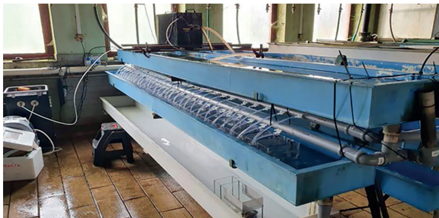
Obr. 16. Kovový stojan s šesti plastovými žlaby umístěnými ve třech patrech (horní patro – žlaby se zásobní vodou, uprostřed – žlaby s inkubačními akvárii, spodní patro – odtokové žlaby) (Foto M. Dvořáková Prokešová).
