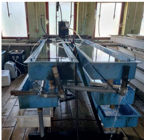
Obr. 7. Experimentální systém pro testování efektu čtyř koncentrací O_3NB na odchov raných stádií na Rybí líně Mydlovary s rybničním (tzn. přirozeně organicky znečištěným) zdrojem vody (Foto M. Dvořáková Prokešová).
