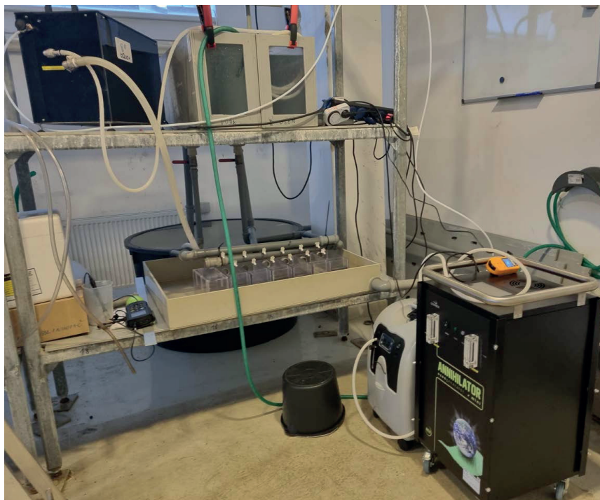
Obr. 6. Testování produkce a koncentrace O_3NB bylo uskutečněno v experimentálních prostorech Ústavu akvakultury a ochrany vod v Českých Budějovicích (vlevo nahoře je generátor nanobublin, vpravo dole koncentrátor kyslíku a generátor ozónu) (Foto M. Dvořáková Prokešová).
