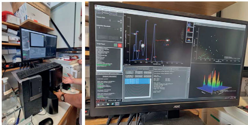
Obr. 9. Koncentrace a velikosti nanočástic ve vzorcích vody byly změřeny NTA analýzou pomocí přístroje NanoSight NS300 (Malvern Instruments Ltd., UK) (Foto M. Dvořáková Prokešová).
