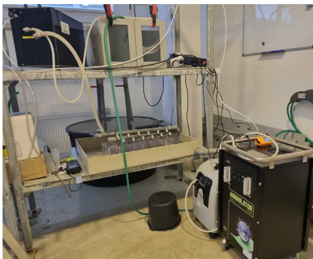
Obr. 4. Testování produkce a koncentrace NB ozonu bylo uskutečněno v experimentálních prostorech Ústavu akvakultury a ochrany vod v Českých Budějovicích (vlevo nahoře je generátor nanobublin, vpravo dole koncentrátor kyslíku a generátor ozónu) (Foto M. Dvořáková Prokešová).
