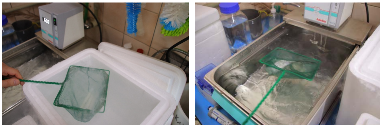
Obr. 10. A) Sítkou přenášíme kryozkumavky z polystyrénové krabice s dusíkem do B) vodní lázně o teplotě 60 °C a rozmrazujeme po dobu 100 s (Foto Sotnikov).
