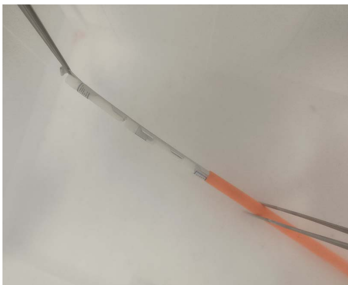
Obr. 7. Ukázka vkládání držáku se třemi kryozkumavkami do gobletu (oranžová trubice) pomocí pinzet pod hladinou kapalného dusíku v polystyrénové krabici (Foto Sotnikov).
