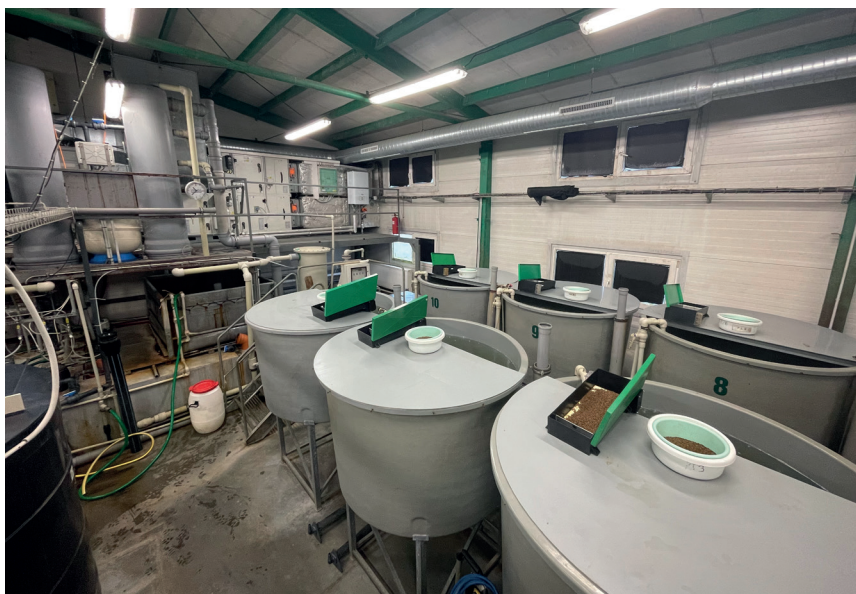
Obr. 18. Experimentální RAS vertikální konstrukce o celkovém objemu 30 m 3 na Fakultě rybářství a ochrany vod JU ve Vodňanech. RAS je zaměřen na odchov násadového materiálu okounovitých ryb pro další chov v RAS (Foto: V. Kučera).
