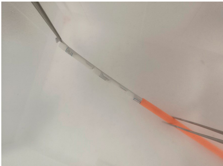
Obr. 7. Ukázka vkládání držáku se třemi kryozkumavkami do gobletu (oranžová trubice) pomocí pinzet pod hladinou kapalného dusíku v polystyrénové krabici (Foto: A. Sotnikov).
