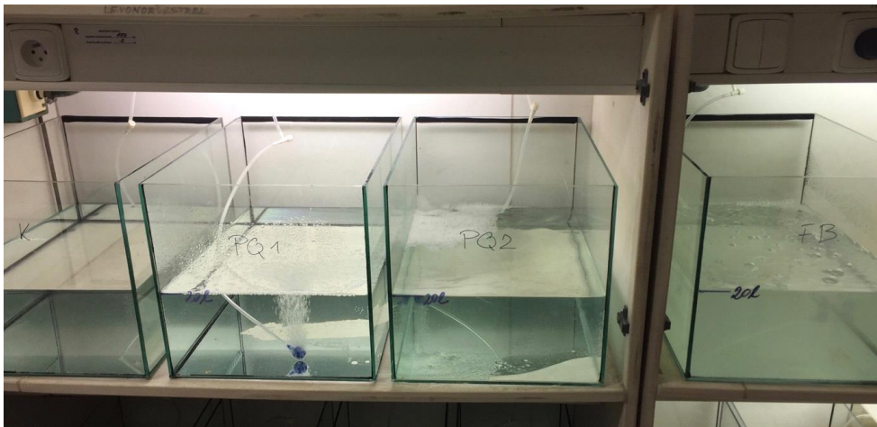
Foto 2: Pokusná skupina 20 l akvárií v laboratorní místnosti připravená na test. Okometricky patrné výrazné zakalení FB koupele (nejvíce vpravo) dané její špatnou rozpustností.
