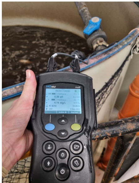
Obr. č. 4. Přenosný multimetr HQ40d (Hach Lange GmbH, Německo) pro měření teploty vody, pH a koncentrace kyslíku ve vodě.
