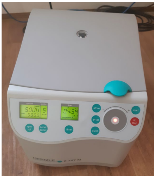
Obr. č. 15. Vlevo – vzorky krve ryb v plastových zkumavkách v polystyrénovém stojánku. Vpravo – centrifuga Z167M (Hermle Labortechnik GmbH, Německo) používaná pro separaci plazmy.
