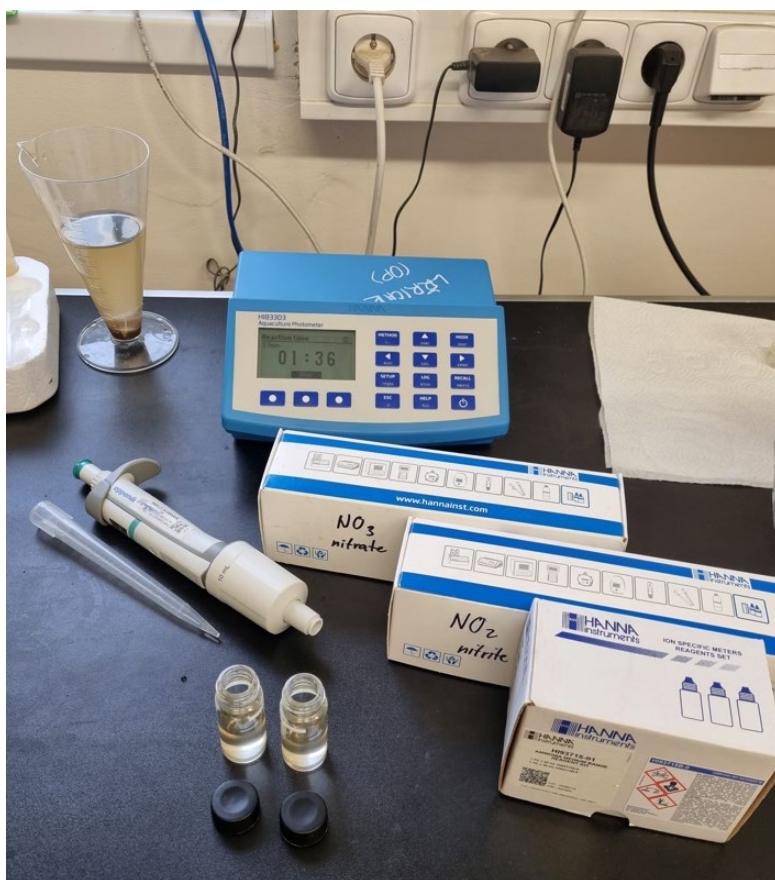
Obr. č. 6. Multiparametrický fotometr Hanna (Hanna, Německo) pro stanovení koncentrace dusíkatých látek ve vodě.
