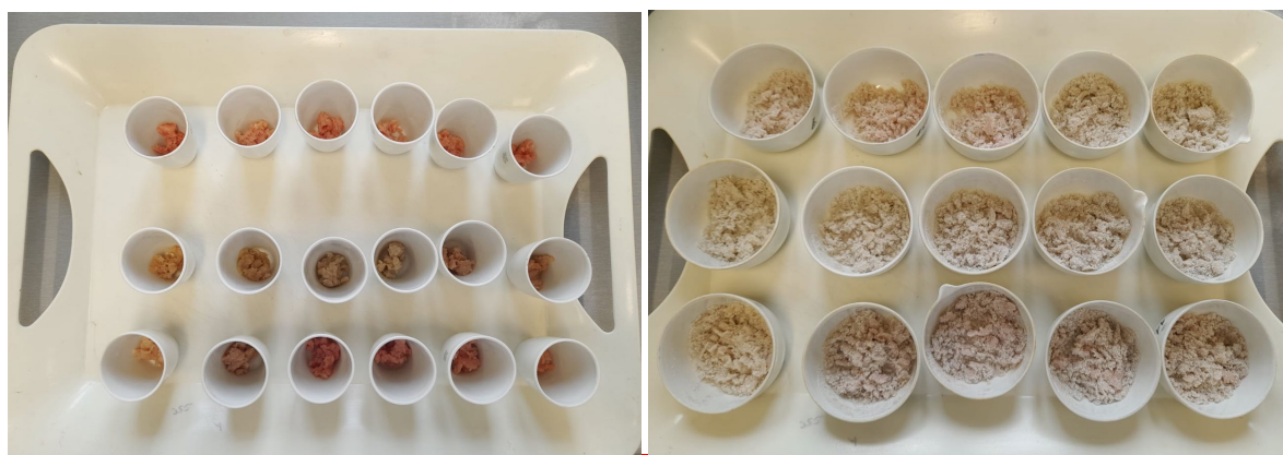
Obr. č. 21. Příprava vzorků pro stanovení obsahu sušiny a popelovin v mase keříčkovce červenolemého.
