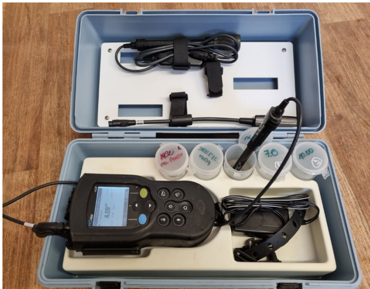
Obr. č. 4. Přenosný multimetr HQ40d (Hach Lange GmbH, Německo) pro měření teploty vody, pH a koncentrace kyslíku ve vodě.
