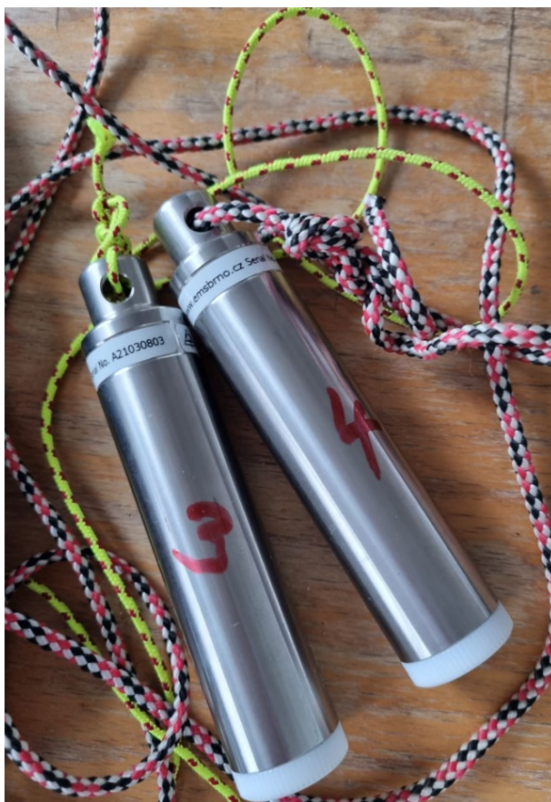
Obr. č. 5. Dataloggery pro automatické kontinuální měření teploty vody v odchovné nádrži.
