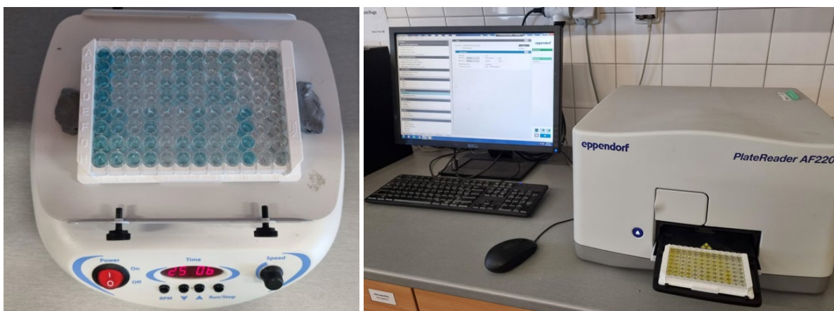
Obr. č. 24. Dokumentace analýz obsahu pohlavních hormonů z plazmy keříčkovce červenolemého (vlevo – automatická třepačka mikrotitračních destiček a vpravo – čtečka mikrotitračních destiček.
