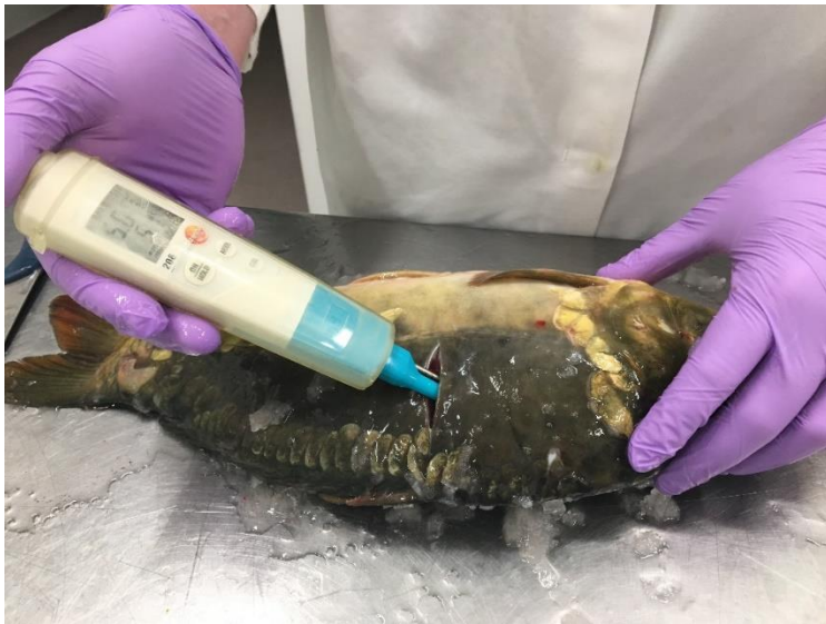
Obr. 8. Měření pH masa pomocí pH metru s penetrační sondou.
