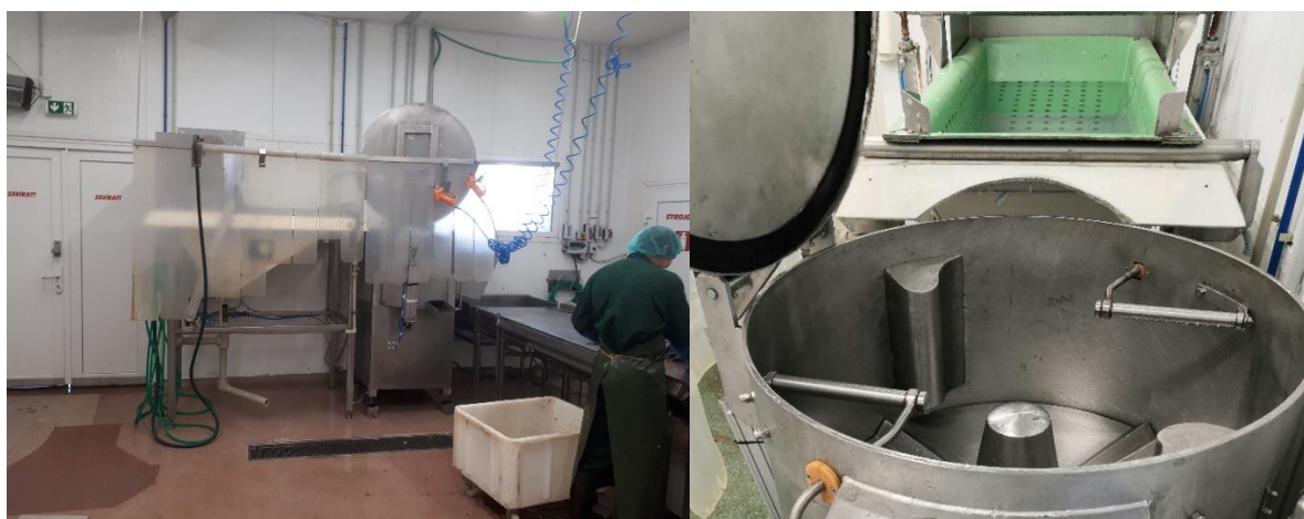
Obr. 5. Vlevo: Boční pohled na elektrickou zabíječku ryb navazující na odšupinovačku. Vpravo: Pohled shora na odšupinovačku a za ní na elektrickou zabíječku ryb s výklopným košem.
