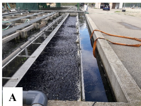
Obr. 2. Jednokomorový plovoucí (A), osmikomorový ponořený biofiltr (B) o celkovém objemu vody 550 m 3 a hluboký airlift (C) recirkulačního akvakulturního systému produkčního podniku BioFish s.r.o.
