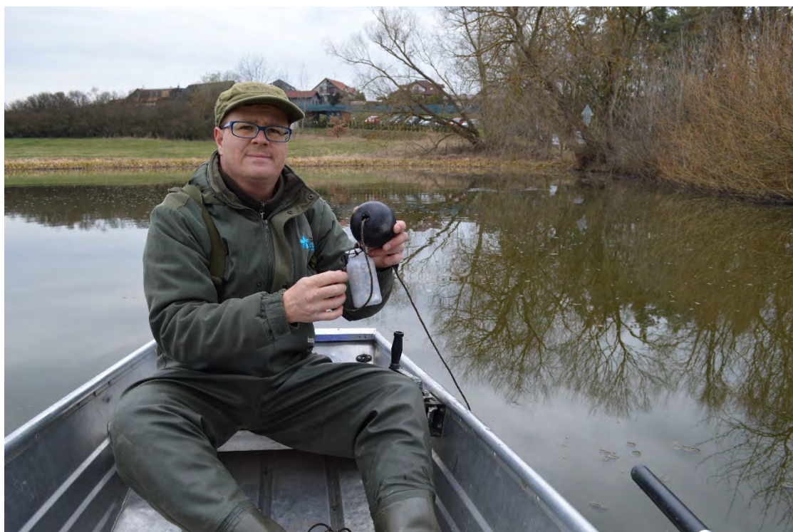
Obr. 4. Instalace automatických záznamových zařízení Minikin-T pro kontinuální monitoring teploty vody (Sirotčí horní).
