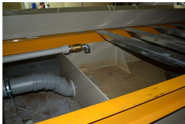
Obr. 14. a 15. Stojan s pěstebními nádržemi (vlevo) a retenční nádrž pěstební části s čerpadlem (vpravo).
