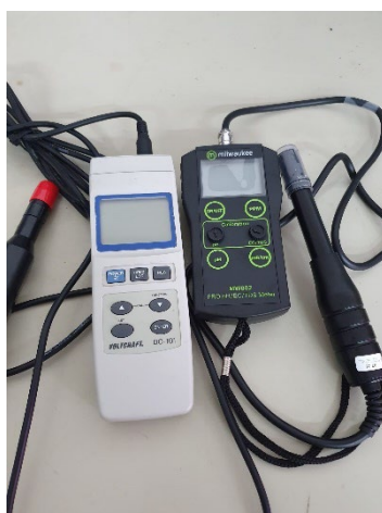
Obr. 5., 6. a 7. Měřicí přístroje pro měření frakcí dusíku (vlevo), rozpuštěného kyslíku a pH (uprostřed) a EC (vpravo).
