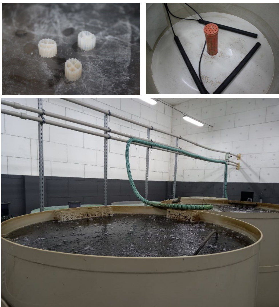
Obr. 37., 38. a 39. Biofiltrační elementy (vlevo nahoře), konstrukce biofiltru se vzduchovacími kameny (vpravo nahoře) a zaběhnutý optimalizovaný biofiltr (dole).
