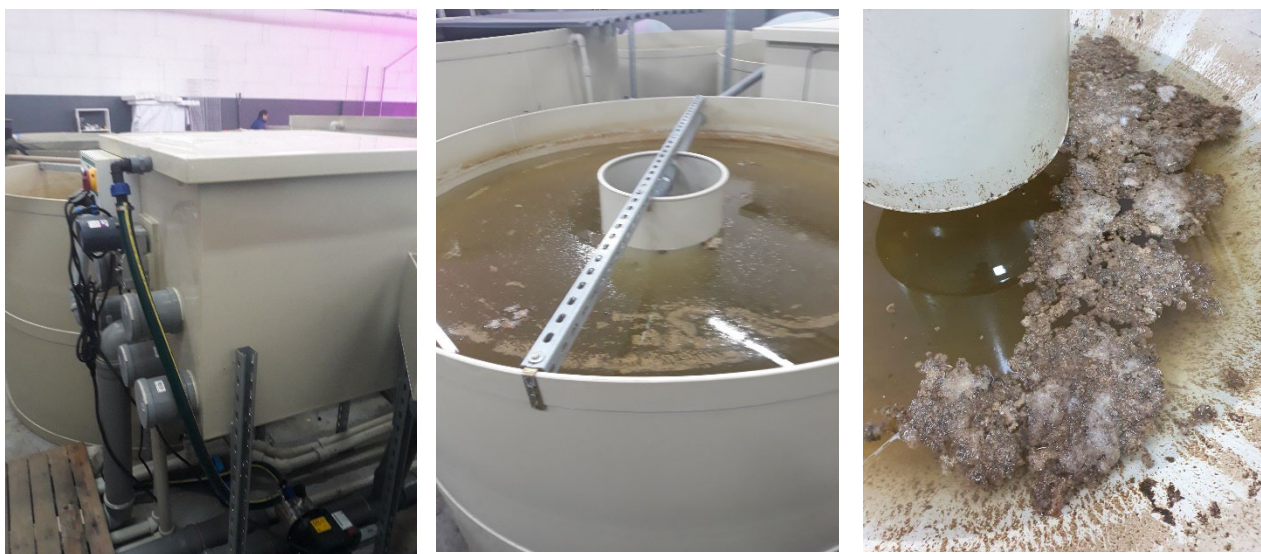
Obr. 32., 33. a 34. Mechanický bubnový filtr (vlevo), radiální filtr pro zahuštění kalů (uprostřed) a zahuštěný kal (vpravo).
